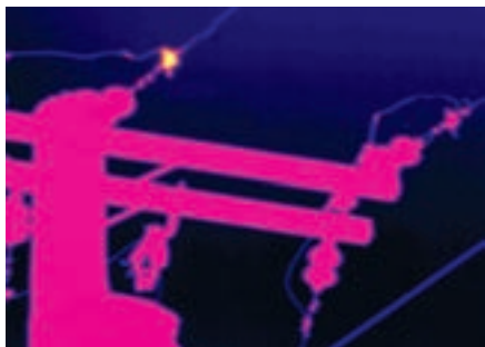
Abbildung 5-16. Eine hochohmige Verbindung an einem Überbrückungsleiter (möglicherweise durch Korrosion verursacht) kann erhebliche Folgen haben, wenn die Last weiter erhöht wird.
