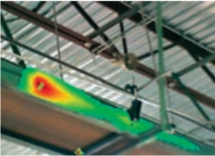
Abbildung 5-67. Ein gegen ein Deckenfördersystem reibender Riemen erzeugt einen Hot Spot in der Wärmesignatur. Der Riemen ist wegen eines in der Nähe befindlichen verschlissenen Rollenlagers falsch ausgerichtet. Erhöhte Reibung trug schließlich zur Überhitzung eines Antriebsmotors bei.
