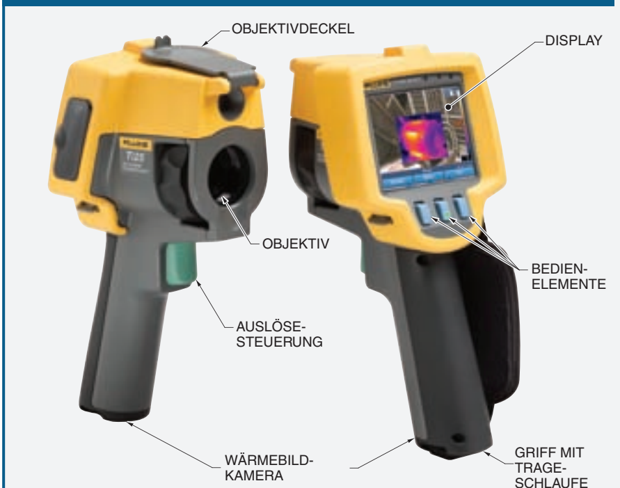
Abbildung 1-4. Typische Wärmebildkameras bestehen aus mehreren gebräuchlichen Komponenten: Objektiv, Objektivdeckel, Display, Bedienelemente und Griff mit Trageschleufe.
