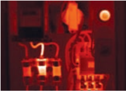
Abbildung 5-44. Ein Sicherungshalter in einer Antriebssteuerung ist ungewöhnlich warm.
