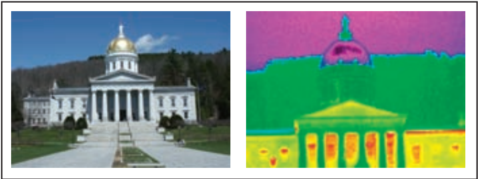
Figura 5-73. La cúpula chapada en oro de un edificio histórico refleja el cielo relativamente frío.
