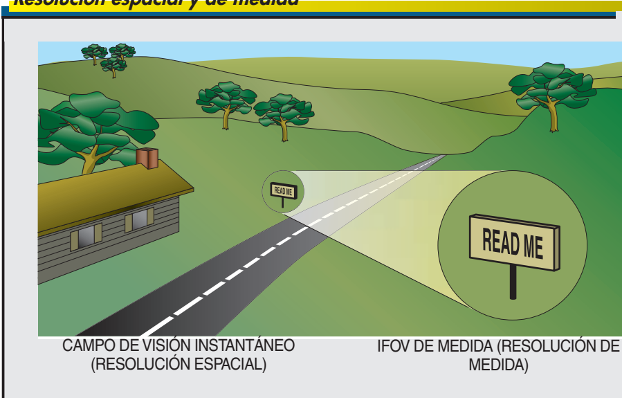
Figura 4-8. El Campo de Visión Instantáneo de medida o IFOVm es la resolución de la medida de una cámara termográfica que determina el tamaño mínimo que debe tener un objeto para que pueda medirse su temperatura con precisión a una distancia concreta. El Campo de Visión Instantáneo (IFOV) es parecido a ver una señal en la distancia mientras que el Campo de Visión Instantáneo de medida (IFOVm) es parecido a leer una señal, bien porque está más cerca o porque es más grande.
