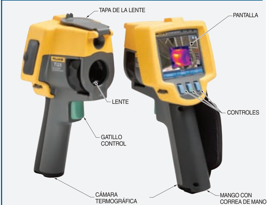
Figura 1-4. Una cámara termográfica típica está compuesta de varios componentes comunes incluyendo la lente, tapa de la lente, pantalla, controles y mango con correa de mano.
