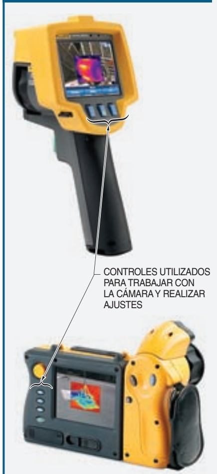
Figura 1-6. Con los controles, se pueden realizar ajustes sobre variables importantes como el rango de temperaturas, el intervalo y nivel térmico, así como otros ajustes.
