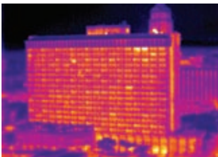
Figura 5-12. Las cámaras termográficas se pueden utilizar para explorar grandes edificios e instalaciones y localizar variaciones térmicas anormales que podrían señalar posibles problemas.
