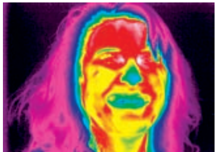
Figura 5-70. La nariz de la cara de una persona suele estar más fría que otras partes de la cara debido al menor flujo sanguíneo y a un mayor enfriamiento convectivo.
