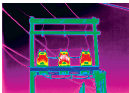
Рис. 5-40. Трансформатор, который теплее других на воздушном блоке, может указывать на возможную проблему.
